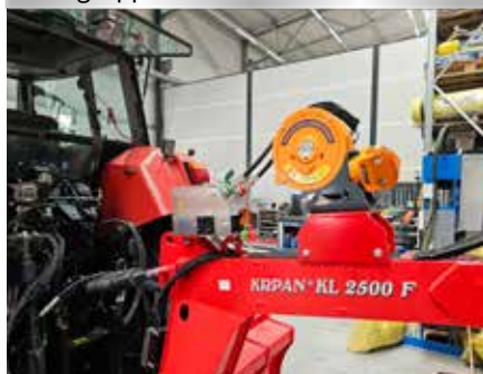
Treuil Sapi + boîtier radio compact sur grappin
