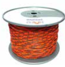
Câble en fibres plastiques de 4,3 mm renforcé Charge de rupture réelle dans l'épissure : 2 200 daN
