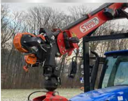
Treuil Sapi sur extrémité de grue
