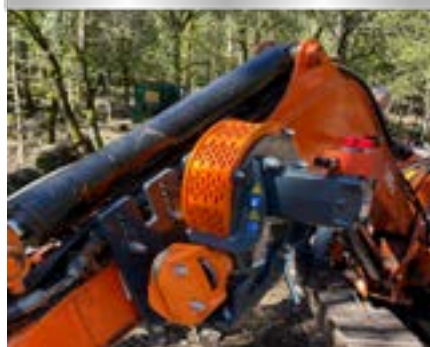
Sapiwinde pro auf Kubota Bagger
