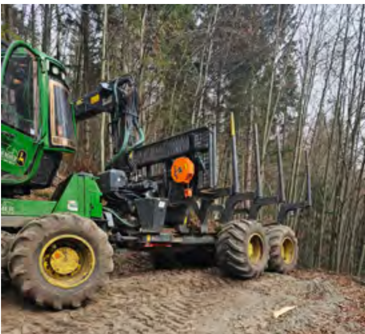
Cabrestante HEAVY en autocargador John Deere con cabrestante de tracción Haas
