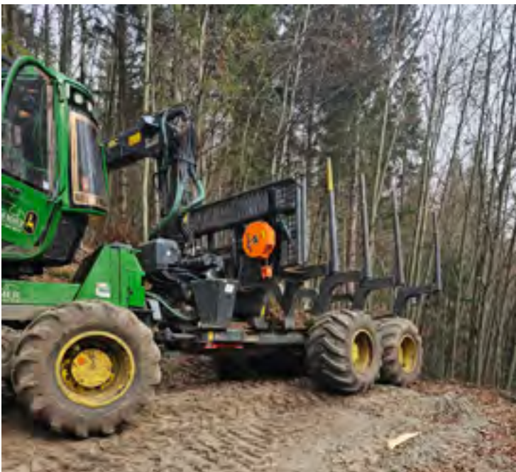
Heavy-vinsch på John Deere-skogsmaskin med Haas-dragvinsch
