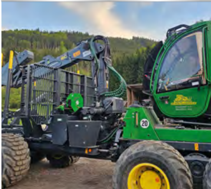
Heavy-vinsch på John Deere-skogsmaskin med Herzog-dragvinsch
